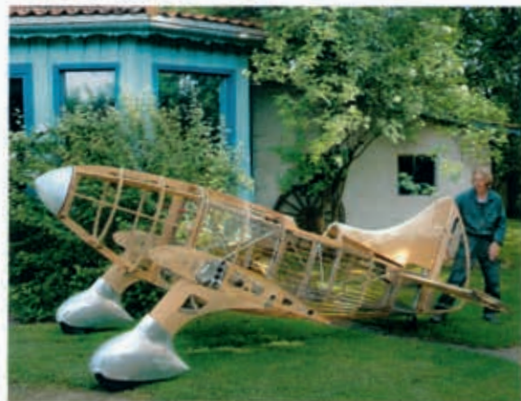
Im Stil der 30er-Jahre: Zurzeit baut Homann sich ein Ultraleichtflugzeug aus Stahl und Fichte
